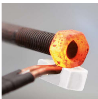
Lossar rostiga skruvar
